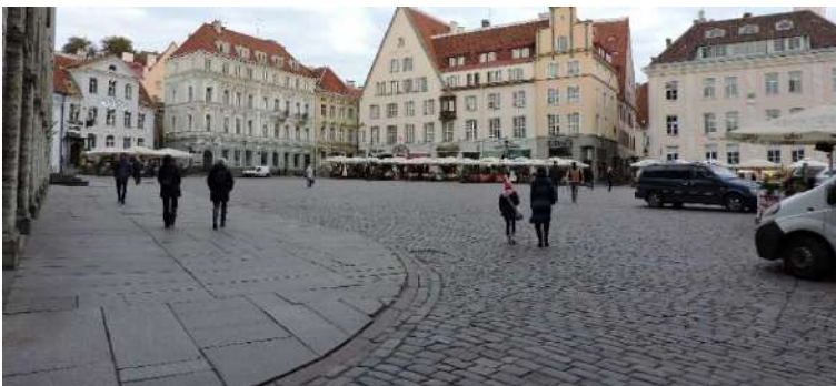
Figura 155: Exemplificări bune-practici: Spații “utilizate în comun”, partajate (“shared-space”), cu o slabă diferențiere a carosabilului și circulației pietonale (nivel comun, textură asemănătoare deși sesizabil diferențiată), în zone centrale și/sau comerciale sau de agrement
