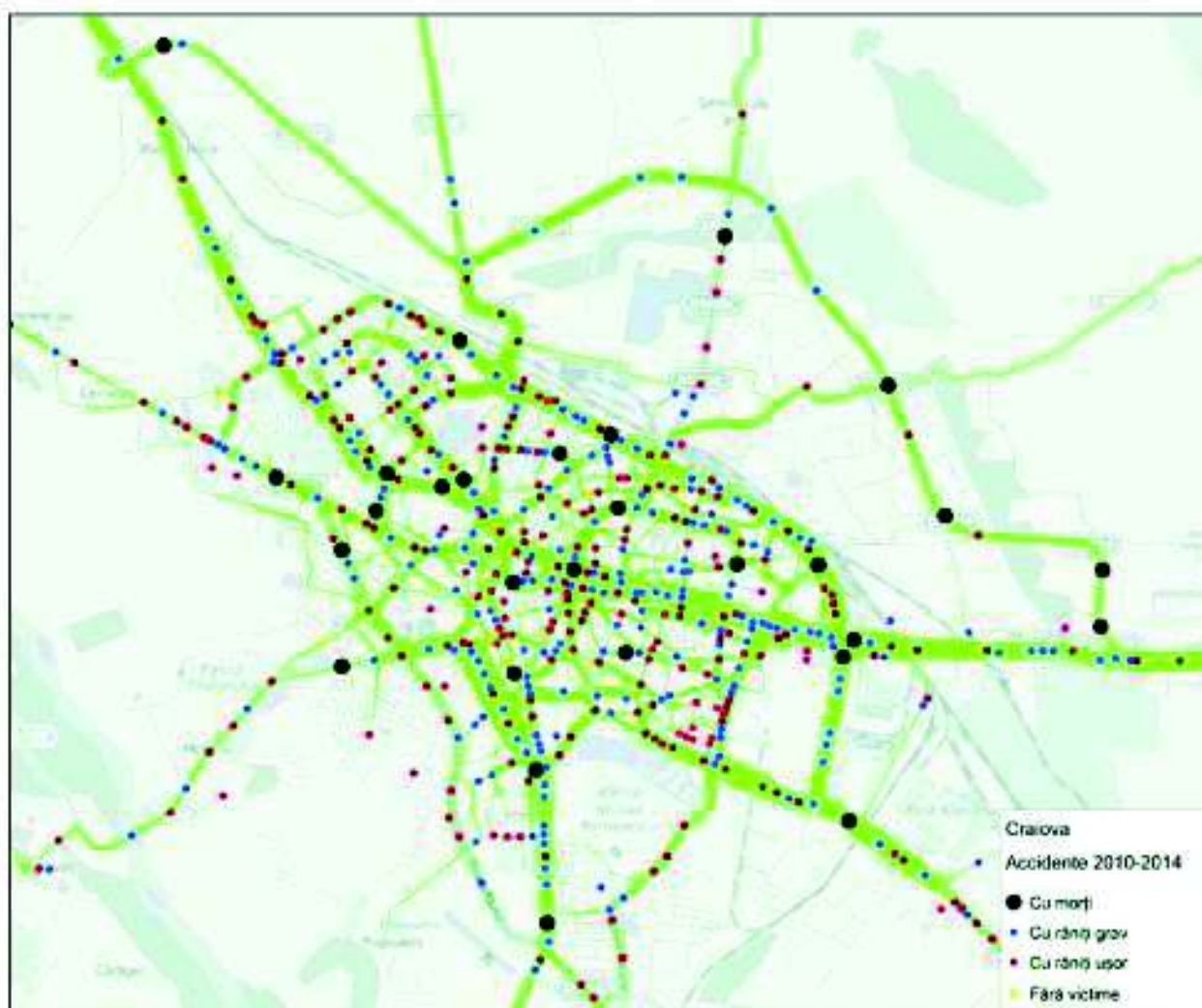
Figura 2.16. Distribuția accidentelor de circulație la nivelul rețelei stradale.
