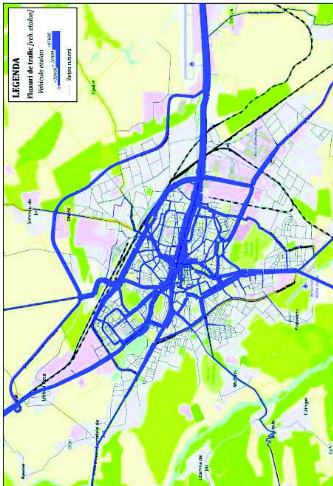
Figura 4.23. Fluxuri de trafic, vehicule etalon, Scenariul "Cu Proiect" MZA 2021 (rotită cu 90°).
