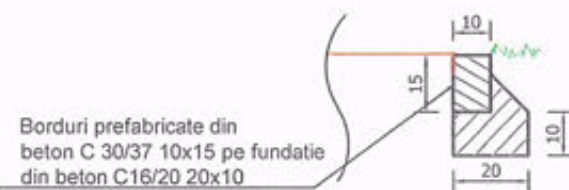
DETALIU B Bordura prefabricata noua 10x15 Scara 1:20
