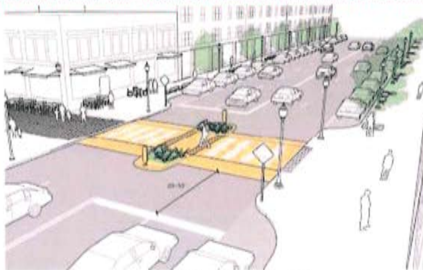
Figura 92. Traversări mediane – Propunere de ridicare a cotei carosabilului la cea a trotuarului
