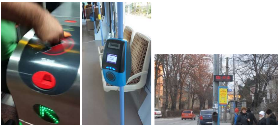
Figura 146: Diferite sisteme de e-ticketing și informare a călătorilor în timp real (Sursa: stânga - TTK, Transport for Ireland)/ Dreapta: Municipiul Craiova (Sursa: arhivă proprie)
