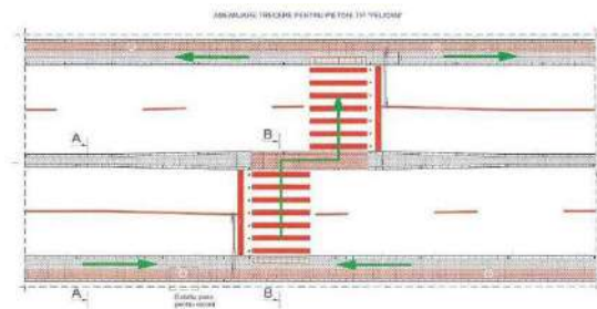
Figura 33: Schema de funcționare a trecerilor pentru pietoni de tip "pelican" (Sursă: Search Corporation- Catalog de măsuri pentru siguranța circulației în satele liniare, 2007)
