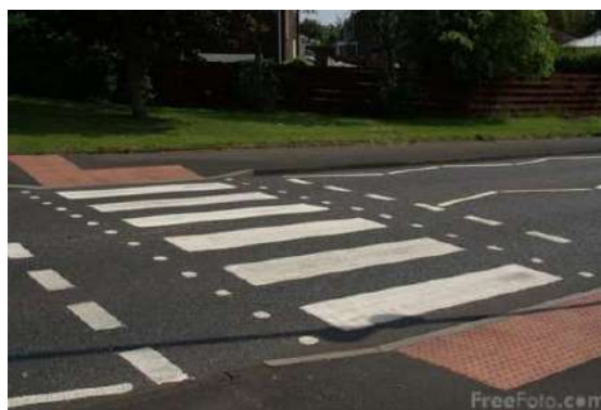
Figura 138: Exemple de amenajări ale trecerilor de pietoni accesibile pentru persoanele cu dizabilități
