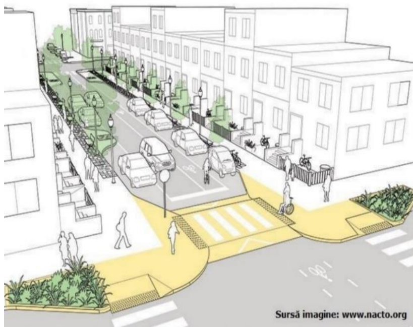
Figură 9-20 - Exemplu amenajare intersecții străzi tip „home-zone”
