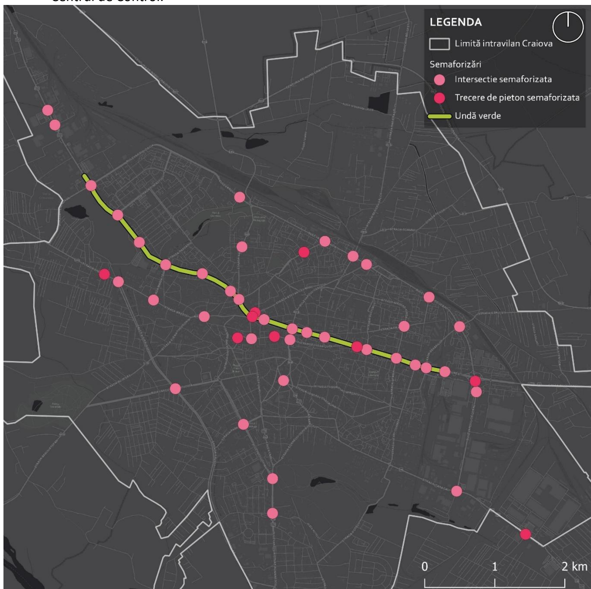
Figură 2-86 - Localizarea traseului de tramvai care beneficiază de prioritatea de tip "undă verde"
